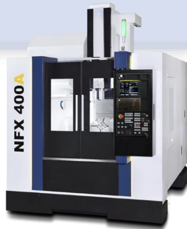
圖 3、五軸立式銑床之示例 (資料來源：YCM 官網)
