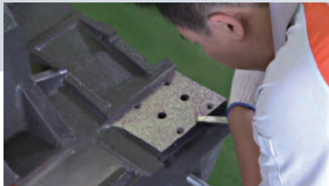
整機接觸面完全超精密級手工刮花
